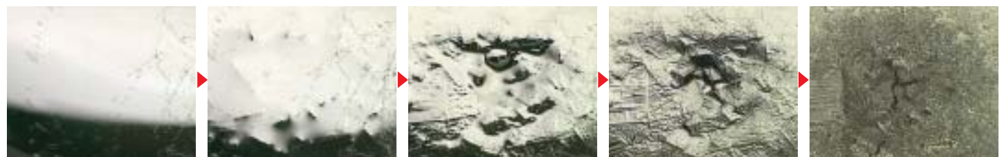
① 液状 ② 金属間化合物の形成 ③ 錫の初晶の形成 ④ 共晶部(低融点)の凝固 ⑤ 凝固完了後の引け巣
