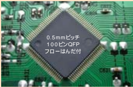
0.5mmピッチ100ピンQFPのフローはんだ付において、ブリッジのない良好なはんだ付が可能です。
